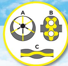
Bomba de vacío (A), con lóbulos (B) o helicoidal (C)
